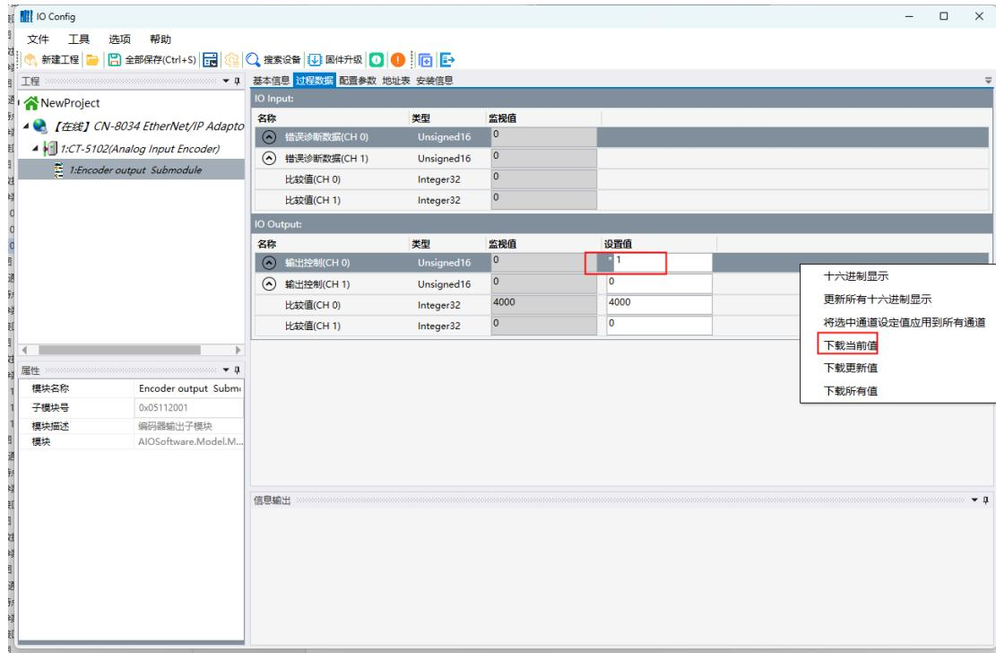
查看错误诊断数据状态，确保比较值设置无误，查看 IO Input 比较值是否与步骤 5 相符，确保参数正确写入。
