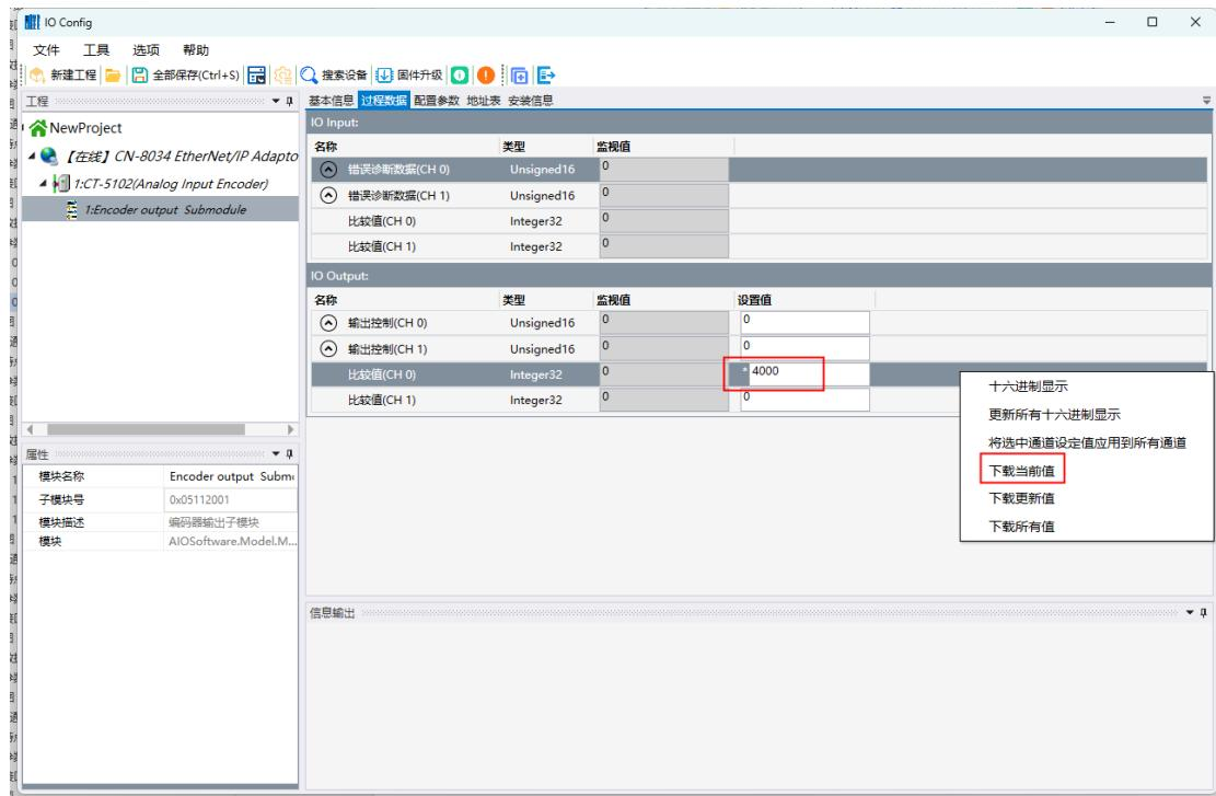
上升沿触发比较控制位，比较值 (CH0) 将被设置为脉冲比较值并锁存。
