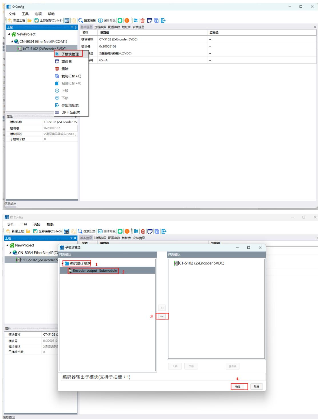
点击耦合器，右键，点击下载配置，完成编码器子模块的添加。
