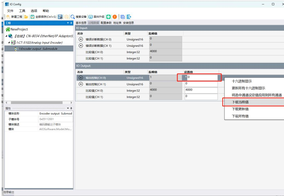
正向转动编码器，监控计数值（CH0）的值，当计数值到达脉冲比较值 4000 后 DO 无输出，当计数值到达 8000 后，清零计数值。
