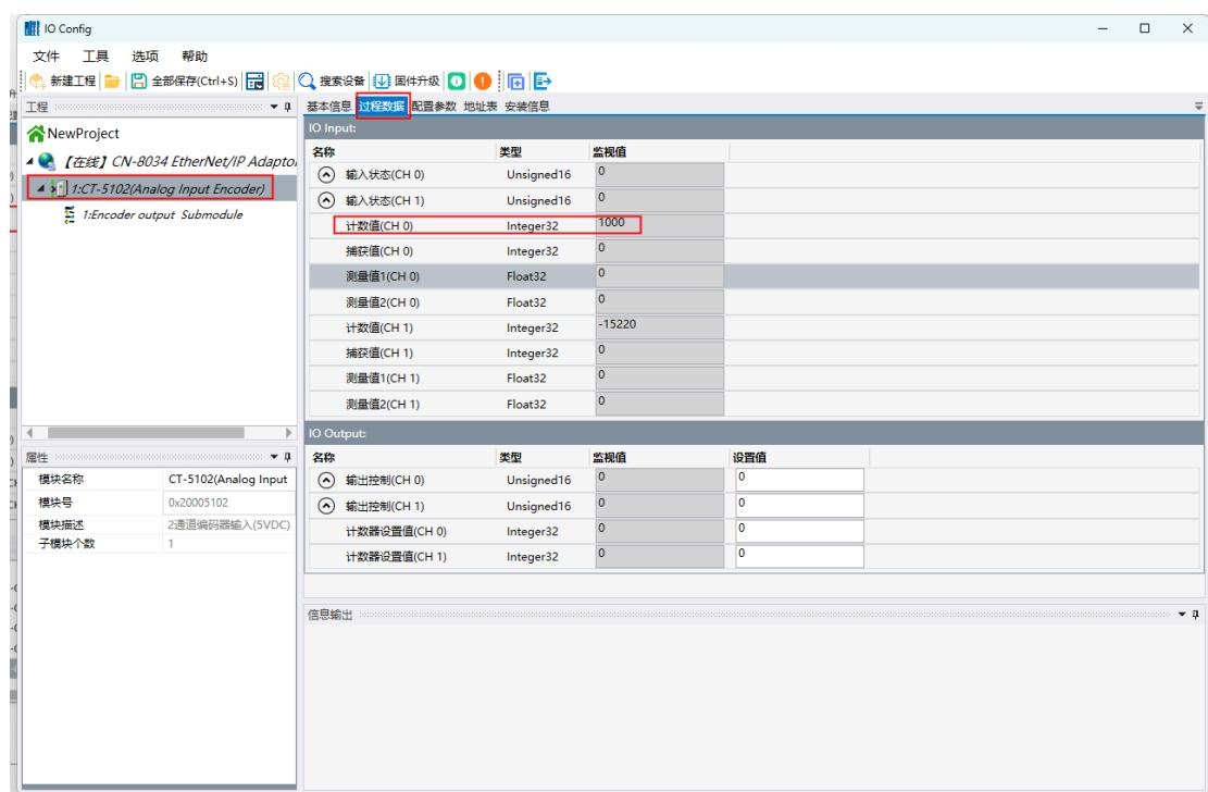
正向转动编码器，监控计数值（CH0）的值，当计数值到达脉冲比较值4000后DO输出高电平信号，当计数值到达8000后，清零计数值并重新开始脉冲比较。
