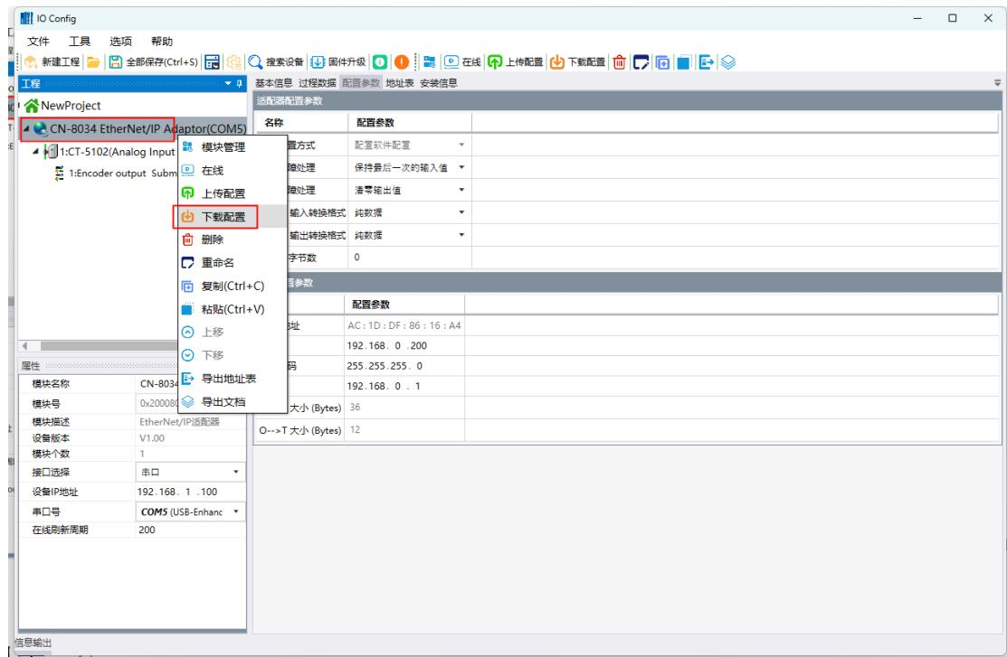
点击耦合器，右键，点击在线，点击 CT-5102 子模块过程数据，选择 10 进制显示。
