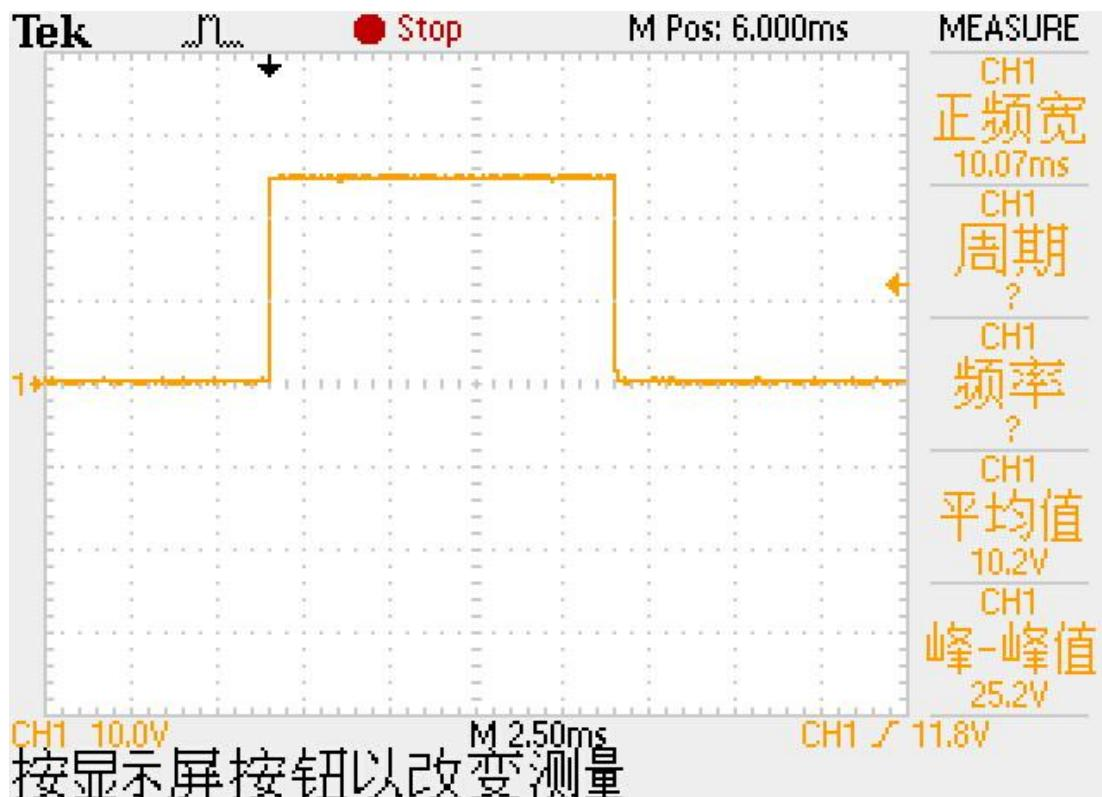
反向转动编码器，监控计数值（CH0）的值，当计数值到达-8000 后，清零计数值。
