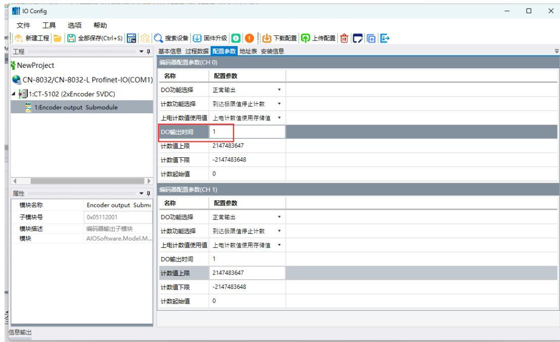
此参数仅 Encoder output Submodule 配置参数 DO 功能选择选项设置为达到比较值输出时有效, 为 DO 输出时间的参数。默认值 1, 取值范围 1-65535, 单位 ms。
